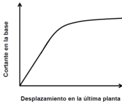
Figura 5.6. Representación gráfica de la curva de capacidad típica (Moreno, 2006)
