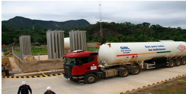
Figura 5. Cisterna criogénica de transporte de GNL
