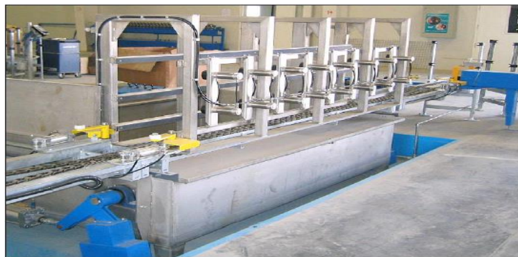
Figura No 14: Equipo de prueba de hermeticidad
