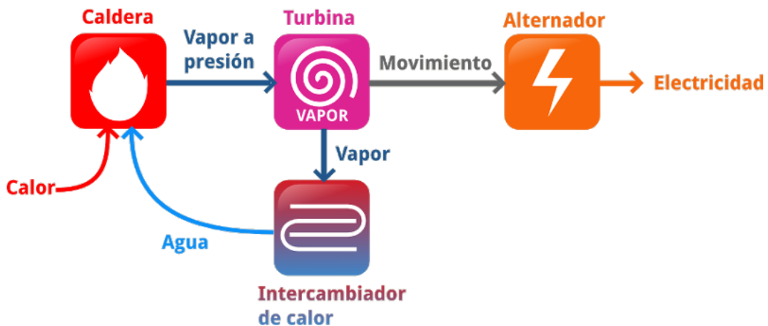
Figura 2.3: Principio de Funcionamiento de una Termoeléctrica
