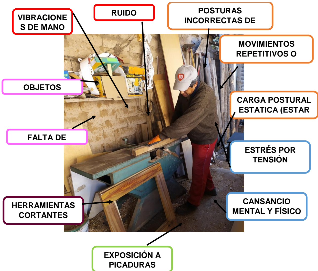
Gráfico 4 Identificación de Peligros en la Cepilladora
