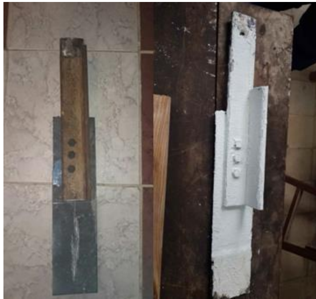
Figura 17. Probeta de conexión atornillada (Elaboración propia)
