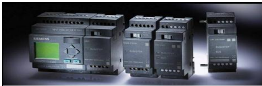
Figura 5: Secuenciador siemens (PLC)
