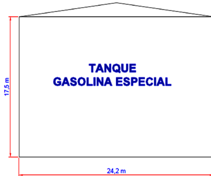
Figura No 2.4. DIMENSIONES DE LOS TANQUES DE GASOLINA ESPECIAL
