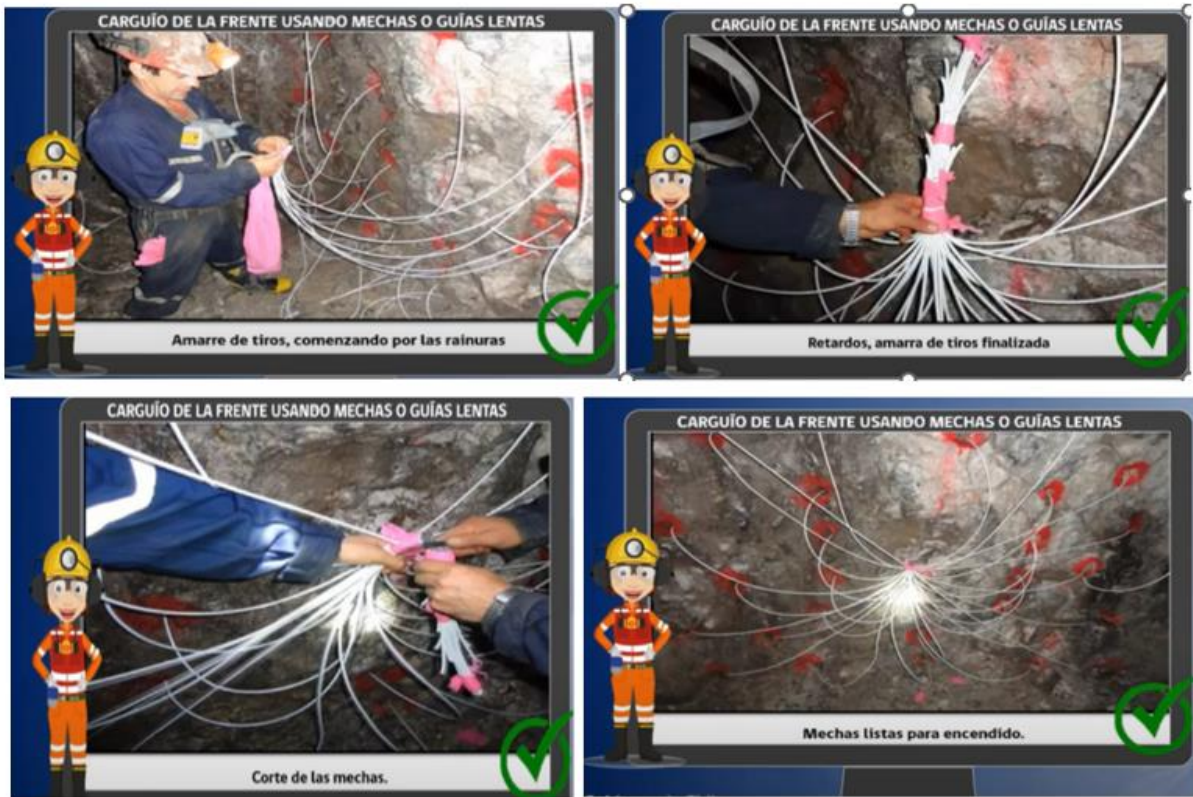
Figura 35: Proceso de encendido de tiros
