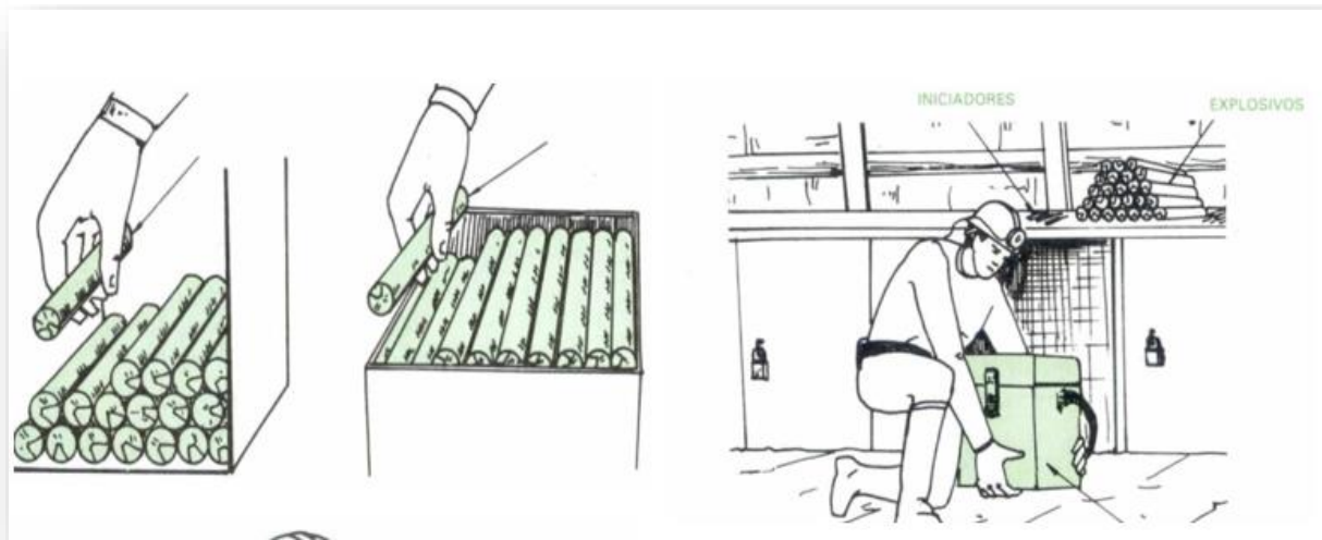
Nota: Carga de explosivos a la caja correctamente (Centro nacional minera SENA, 2018)
