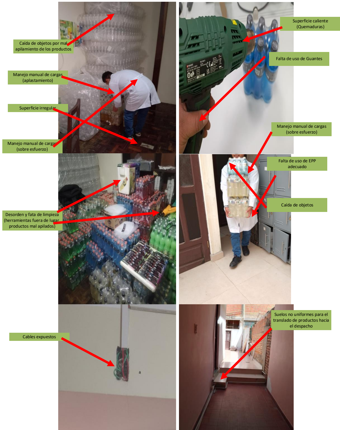
Figura 8: Identificación de peligros en el área de almacén
