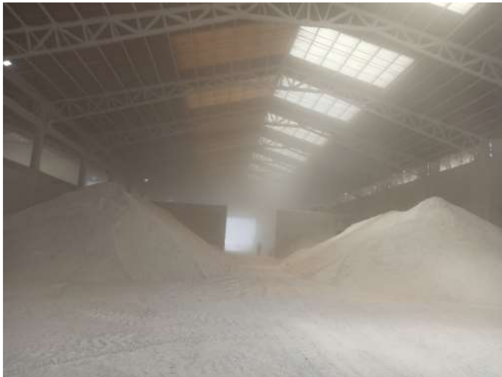
Figura A-4: Contaminación por el polvo dentro de la planta Fuente: SOCCOMAVK S.C.
