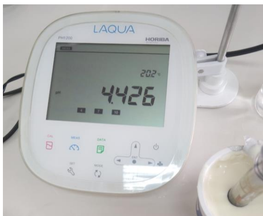
Figura 24 Lectura de pH de la muestra de yogurt griego
