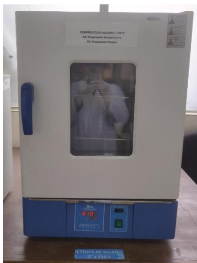
Figura 17 Deshidratado de la muestra
