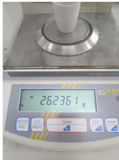
Figura 20 Pesado de crisol más muestra
