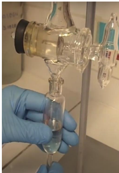
Figura 12 Adición de alcohol amílico
