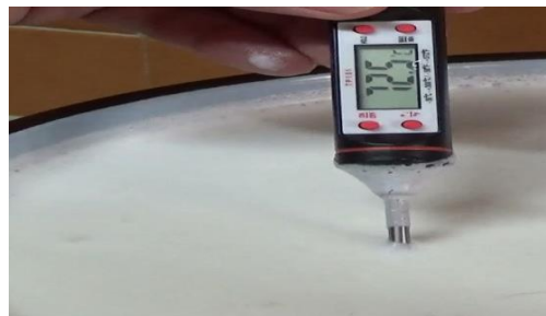
FIGURA 6: Pasteurización Alta De La Leche A 80°C.
