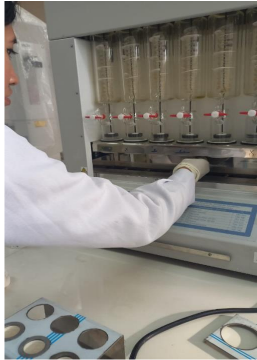
Figura 12. Medir 50ml de éter de petróleo y Llevar el vaso al equipo y engancharlo
