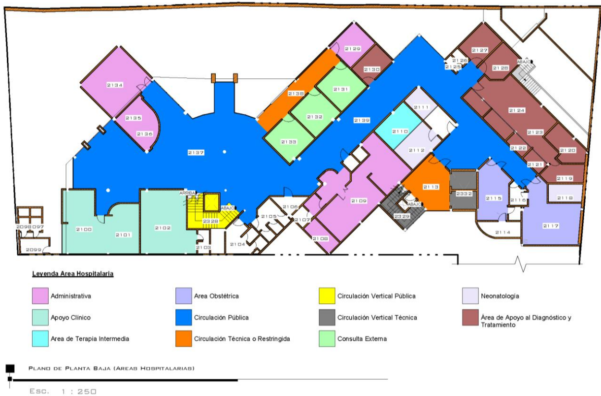
Figura 16 Áreas Hospitalarias Nivel Planta Baja
