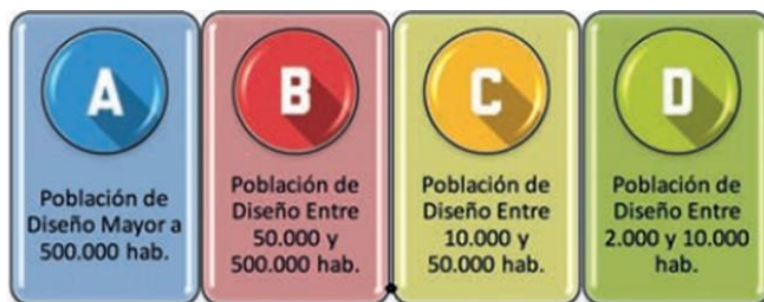
Imagen N° 12. Categorías de una PTAR en base a criterios de población de diseño
