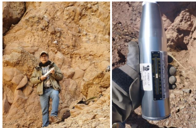
Ilustración 12. Ensayos de campo, martillo de Schmdt.
