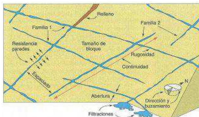
Ilustración 15. Representación esquemática de las propiedades geométricas de discontinuidades (Hudson, 1989)
