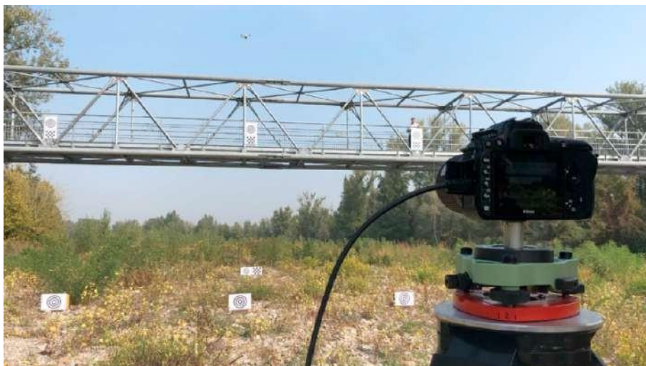
Figura 2.7: Configuración experimental del sistema de monitoreo basado en visión por cámaras en una pasarela metálica en Italia.
