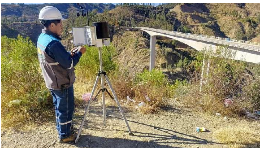
Figura 5.5: Estación meteorológica portátil utilizada durante la campaña de medición.
