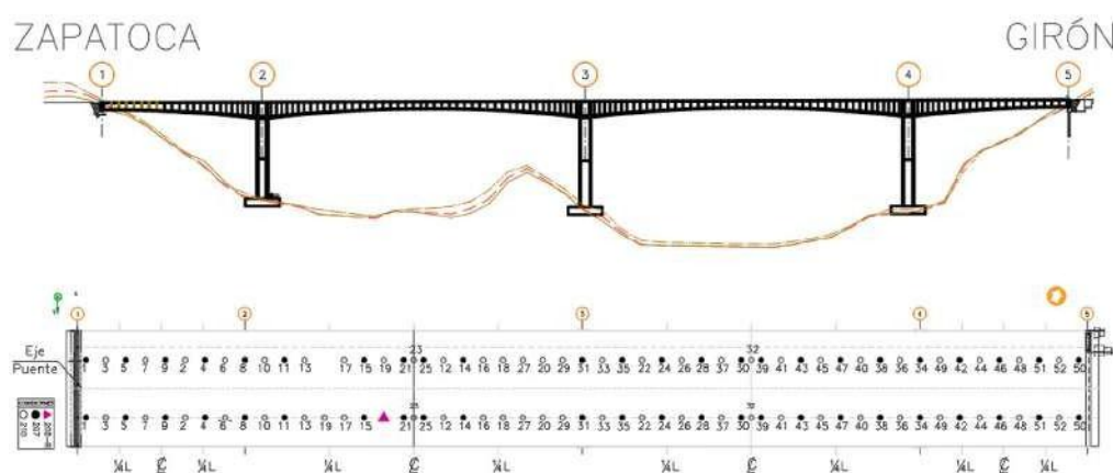
Figura 3.1: Ubicación de los sensores en el puente Gómez Ortiz.
