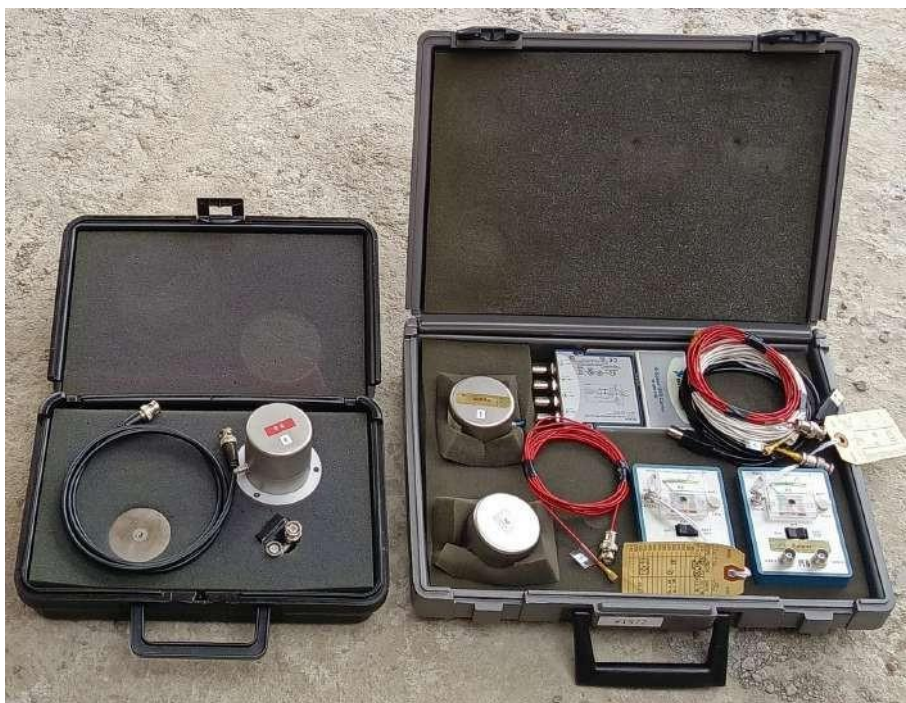
Figura 5.1: Equipo de sistema de adquisición de respuesta vibratoria.
