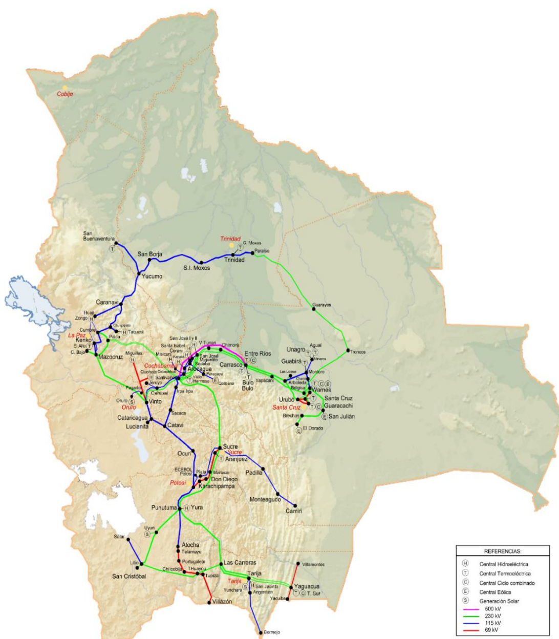
Figura 2-1 Diagrama Unifilar del SIN de Bolivia (2023)
